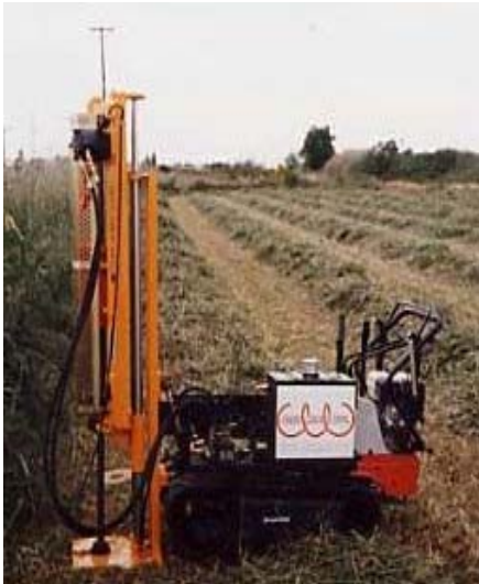
Fotografia 2: Penetròmetre dinàmic ROLATEC ML-60-A
