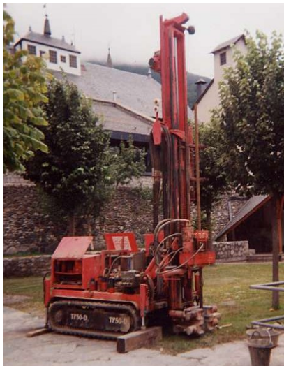
Fotografia 1: Sonda de perforació TP-50.
