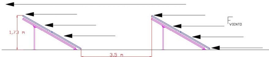
Debido a este resguardo se tiene en consideración una reducción en la presión dinámica del viento del 25%.
